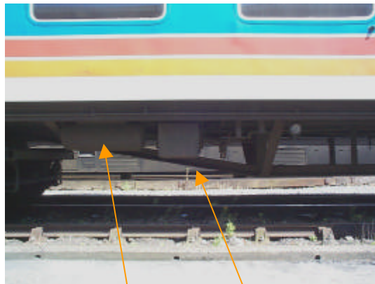
Aux. Reservoir & EP brake unit
